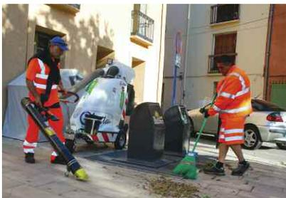
Depuis le mois d'avril, le service est équipé d'un Glutton®, un aspirateur électrique de déchets urbains. « *Chaque jour, on aspire l'équivalent de 240 litres de déchets. La machine est 100% silencieuse et très maniable. Elle est parfaitement adaptée aux circuits fermés* » souligne Alex Benjema qui utilise le Glutton® au quotidien.
